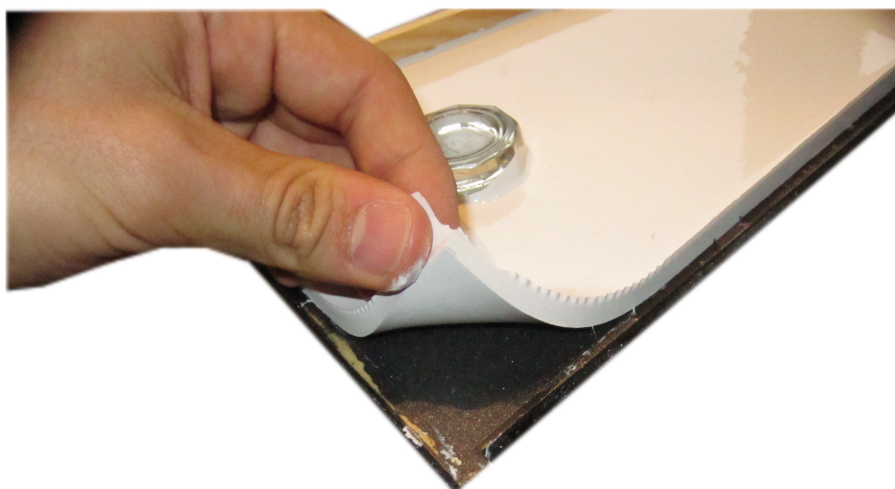
Abbildung 55: Bildung des Negativs mit Silikon
