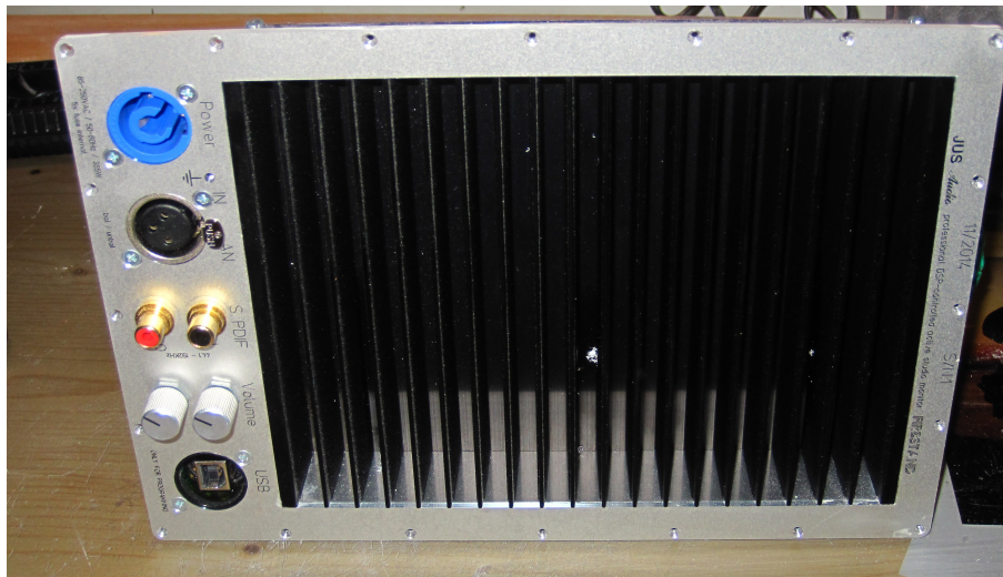
Abbildung 53: Rückplatte mit Anschlüssen und Kühlkörper
