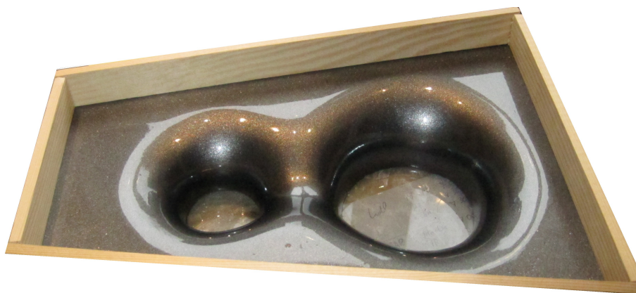
Abbildung 54: Horn Positiv, lackierter Elektrikergips
